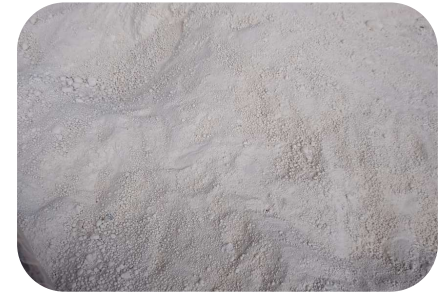
Output : WTP Sludge @15% Moisture
